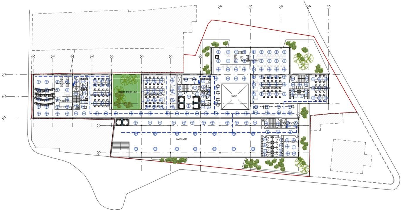
Figura 49 Pontos de luz em pavimento-tipo. Fonte: Consultoria
