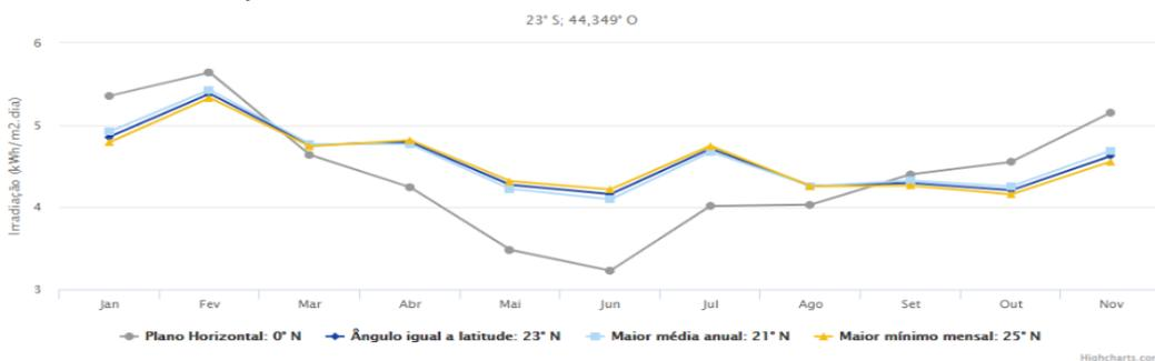
Figura 13 Cálculo Plano Inclinado - Irradiação Solar. Fonte: CRESESB
