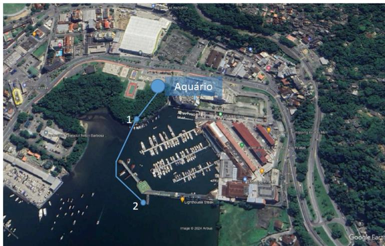
Para abastecimento da água salgada, recomendamos a implantação de uma sistema de captação de água marinha formado por uma casa de bombas e reservatório de decantação (1), que poderão ser instalados próximo ao rancho de pesca e uma ponteira / pré-filtro (2) que poderá ser instalada junto a parte externa do molhe da marina.
